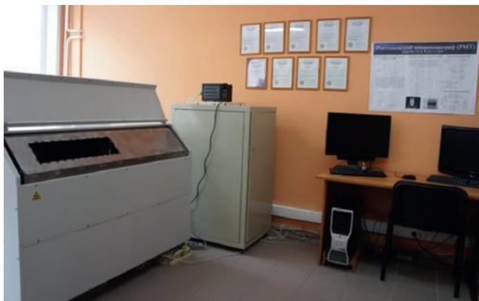
*Рис. 1. Цифровой рентгеновский 3-D микротомограф*
