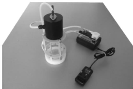
**Рис. 7.** Вискозиметр В-200А
