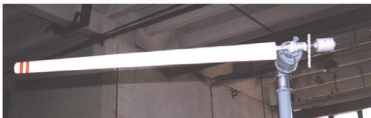
**Рис. 8.** ВЭУ-1 мощностью 1 кВт.
