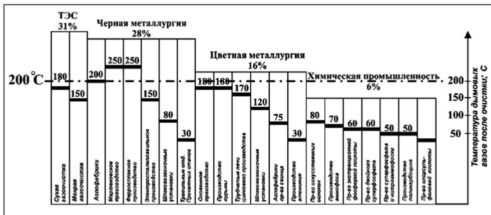
Рис. 1. Температура и доля выбросов в атмосферу для основных видов производств
